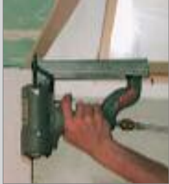
Tackern – Paneele und Profilholz schnell und sicher befestigen
