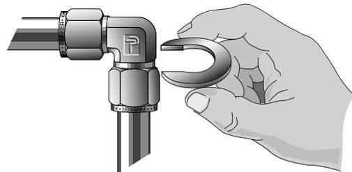
1. Nach fingerfestem Anzug werden Verschraubungen der Größe 1/4" bis 1" (6mm bis 25mm) mit 1 1/4 Umdrehungen, Verschraubungen der Größen 1/16", 1/8" und 3/16" (2, 3 und 4mm) mit 3/4 Umdrehungen mit einem Schlüssel fertigmontiert.
