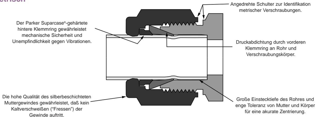
Parker Rohrverschraubungen für Instrumentierung werden komplett montiert und einsatzbereit geliefert. Beim Anziehen der Mutter wird der vordere Klemmring durch den Innenkonus des Körpers auf das Rohr gepreßt und verformt diesen plastisch; es resultiert ein druck- und vakuumdichter Kraftschluß zwischen Rohr und Verschraubung. Der hintere Klemmring wird durch den Konus des vorderen in das Rohr gedrückt, wodurch ein fester mechanischer Halt des Rohres entsteht.
